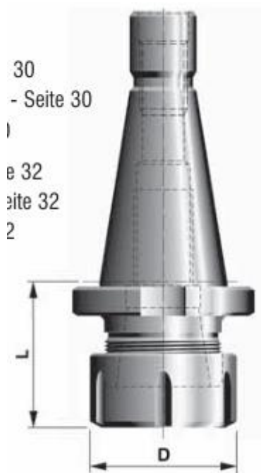
Рисунок 3.15 - Для свердла, зенківки обираємо цанговий патрон DIN2080 ISO 40 - 591 027 - 14 40×ER40 [7, с. 21]
