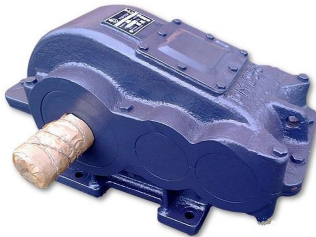
Рисунок 1.3 – Циліндричний редуктор серії РМ-1000
