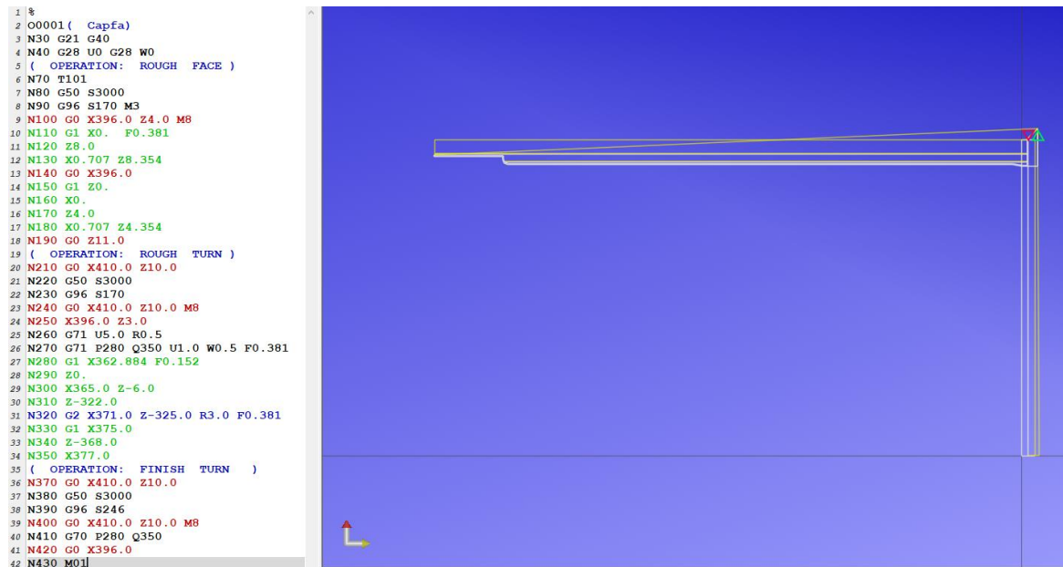
Рисунок 3.13 – Траєкторії переміщень інструментів першого установу у CIMCO Edit
