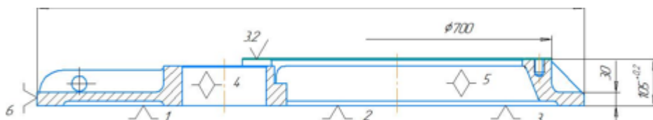
Рисунок 1.8- Теоретична схема базування кришки редуктору
