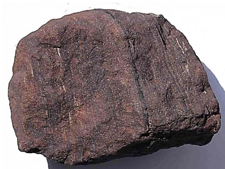
Рис. 2.10. Багата дисперсногематит-мартитова руда. Розмір зразка за максимальним виміром 7 см.
