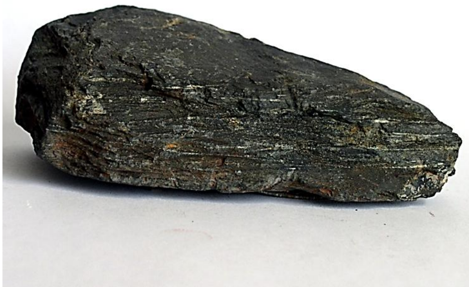
Рис 2.13. Кварц-хлоритовий сланець третього-п'ятого сланцевого горизонту. Текстура сланцювата, структура тонкоколоскувата.
