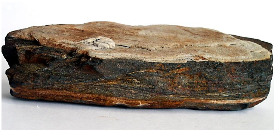
Рис. 2.2. Тонкосмугастий маршалітизований залізнослюдко-мартитовий кварцит. Розмір зразка за максимальним виміром складає 12 см.
