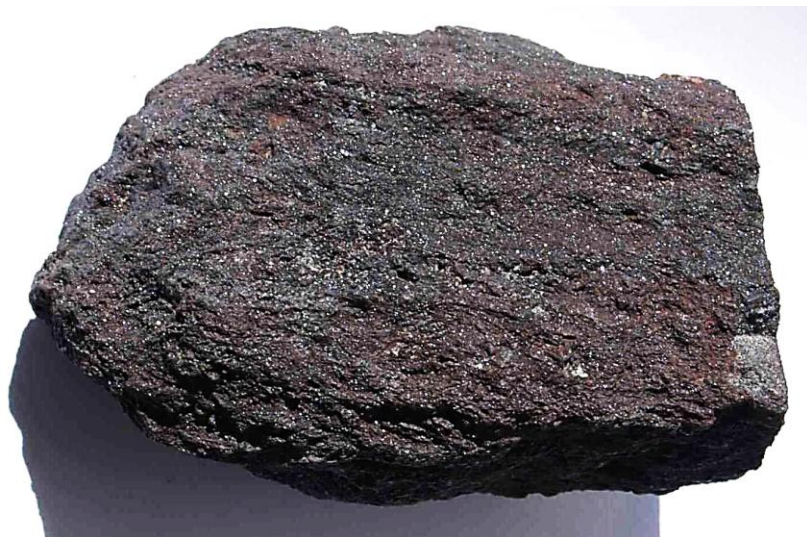
Рис. 2.9. Багата залізнослюдко-мартитова руда. Розмір зразка за максимальним виміром 8 см.
