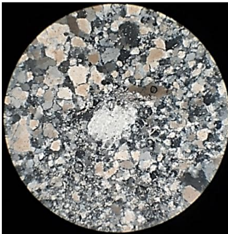
Рис. 3.9. Шліф зразка 72. Кварцит білий; прохідне світло; ніколі схрещені; збільшення 20 x .
