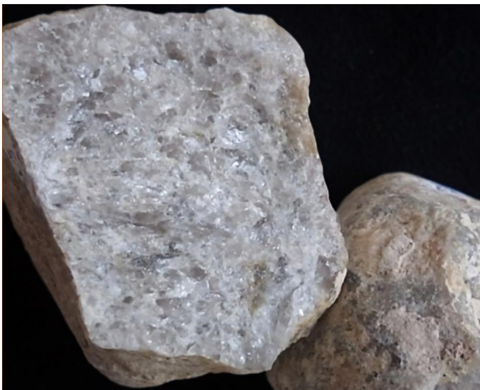
Рис. 3.2. Зразки гальки з жильного кварцу.
