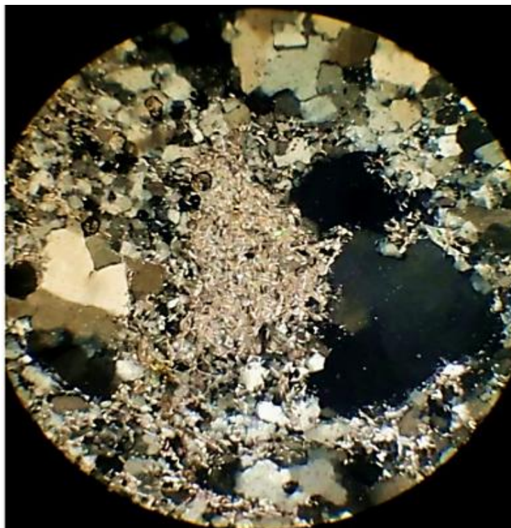
Рис. 3.10. Шліф зразка 96. Галька з ядром; серицитове гніздо серед зерен кварцу; прохідне світло; ніколі схрещені; збільшення 20 х .
