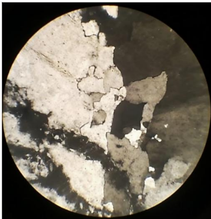
Рис. 3.12. Шліф зразка з розпадом великого зерна на більш дрібні частки; прохідне світло; ніколі схрещені; збільшення 20 x .
