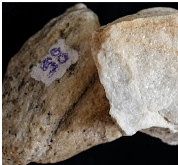
Рис. 3.4. Зразки гальки з цукроподібного білого кварциту.
