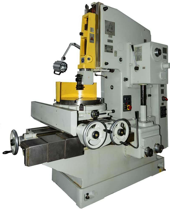
Рисунок 1.19 – Довбальний верстат ГД200
