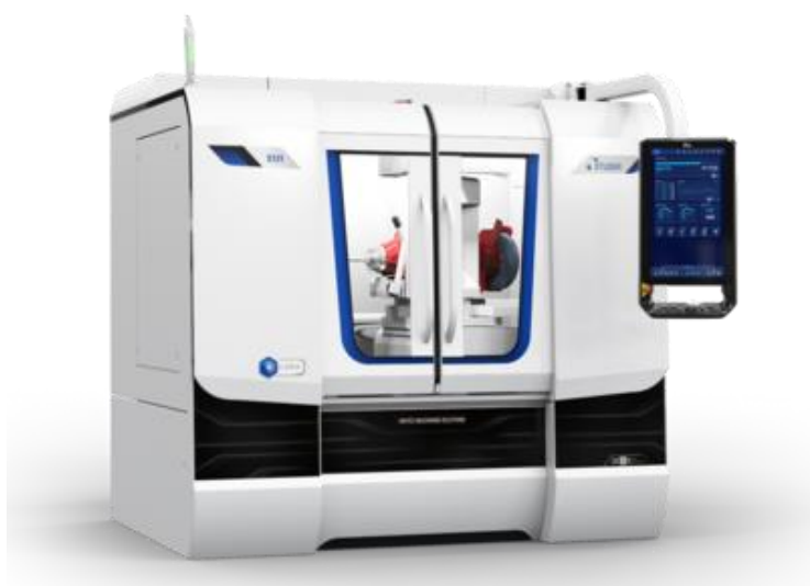
Рисунок 1.20 – Круглошліфувальний верстат Studer S121
