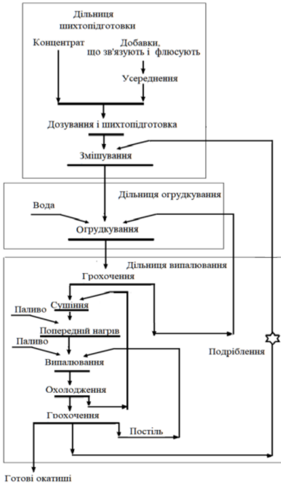
Рисунок 1.1 – Схема виробництва окатишів з термообробкою у цеху випалу
