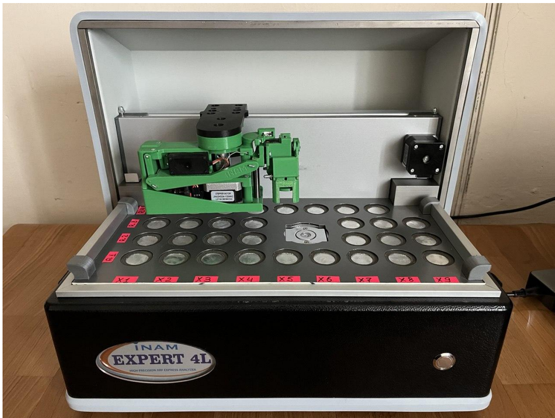
Рисунок 2.1 – Зовнішній вид рентгенофлуоресцентного аналізатора EXPERT 4L для визначення хімічного складу шихтових матеріалів
