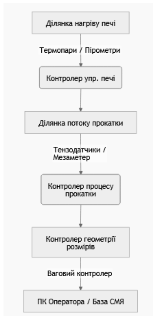
Рис. 2.9. Структура інформаційних потоків і взаємодія елементів системи контролю у виробничому процесі.
