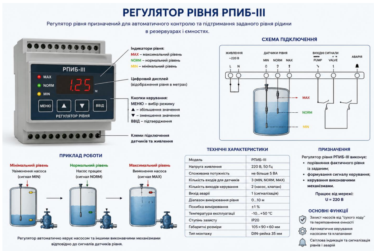
Рисунок 1.4 – Регулятор рівня РПИБ-III
