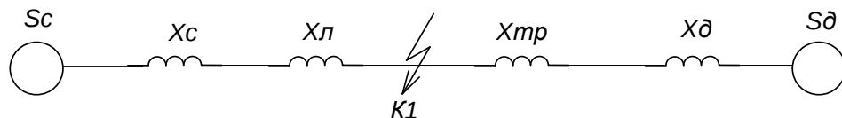
Рисунок 3.2 – Схема заміщення для точки K 1
