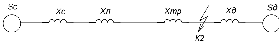
Рисунок 3.3 – Схеми заміщення для точки K_2
