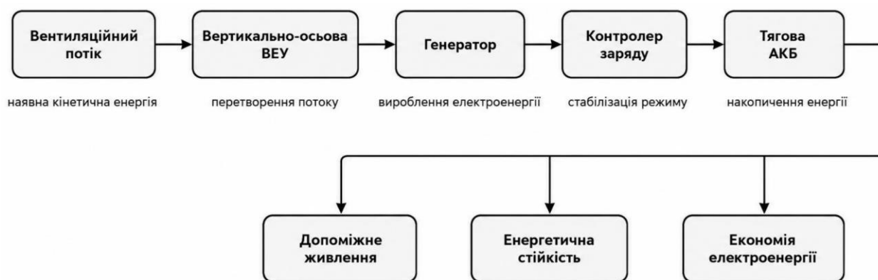
Рисунок 1.1 – Концепція використання локального ВДЕ в підземному руднику
