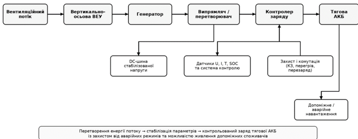
Рисунок 1.5 – Структурна схема вітрозарядної станції для заряду тягових АКБ
