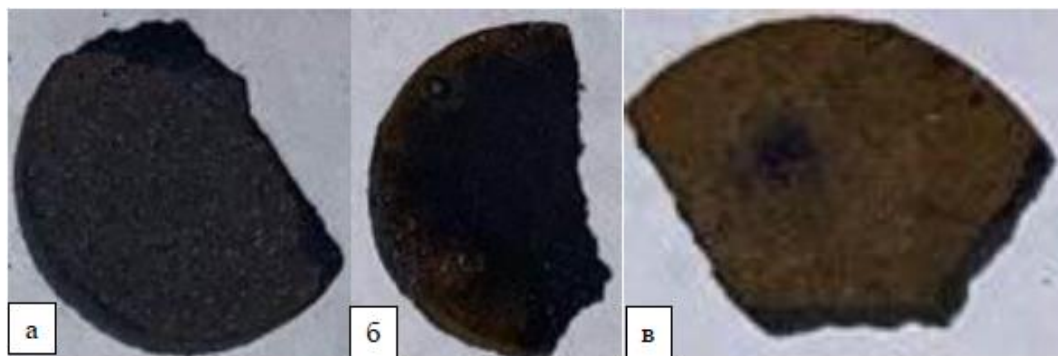
Рисунок 3.2 – Зовнішній вигляд зразків після ізотермічної витримки при температурі 1300 °С у контакті з вуглецем по поверхні: а – 1 година; б – 2 години; в – 5 годин.
