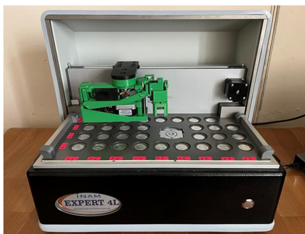
Рисунок 2.2 – Лабораторний рентгенофлуоресцентний спектрометр EXPERT 4L
