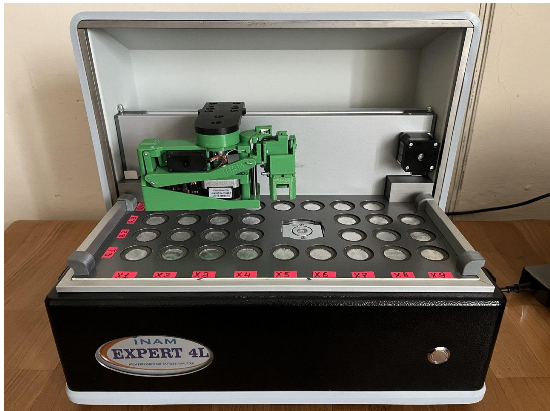
Рисунок 3.1 – Рентгенофлуоресцентний прилад EXPERT 4L для дослідження складу шихти
