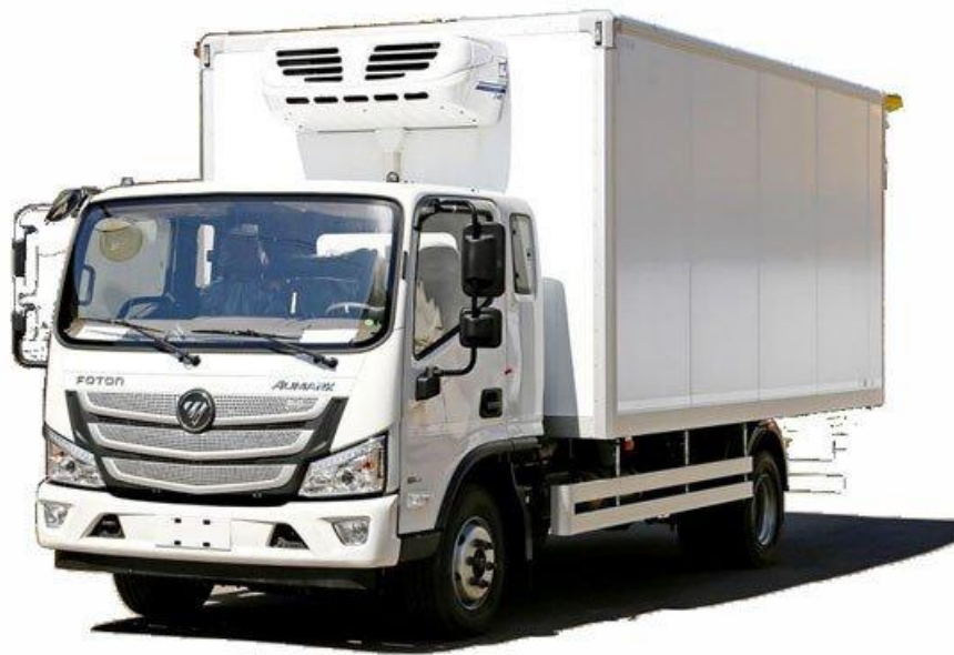
Рис. 2.2 Автомобіль FOTON VJ вантажопідйомністю 2500 кг
