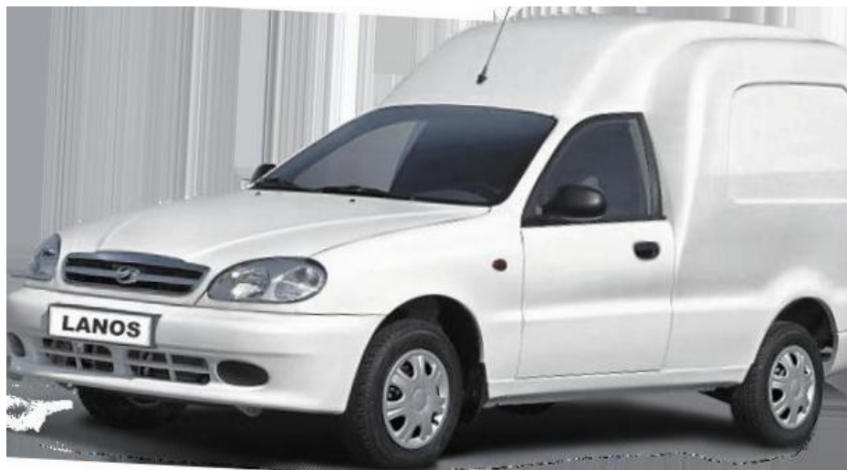
Рис.2.1 Автомобіль ЗАЗ Lanos Pick-уп вантажопідйомністю 530 кг
