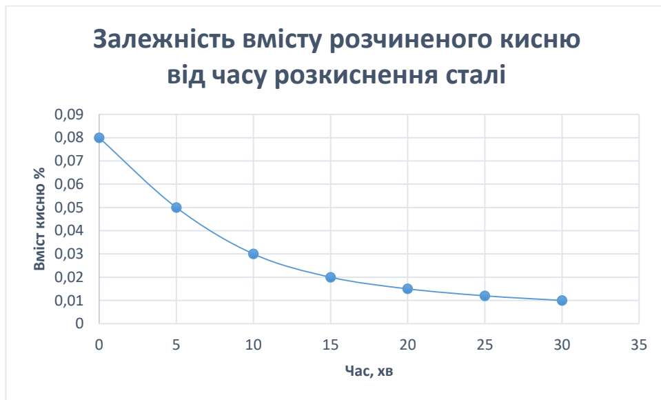
Графік 3.1 Залежність вмісту розчиненого кисню від часу розкиснення сталі
