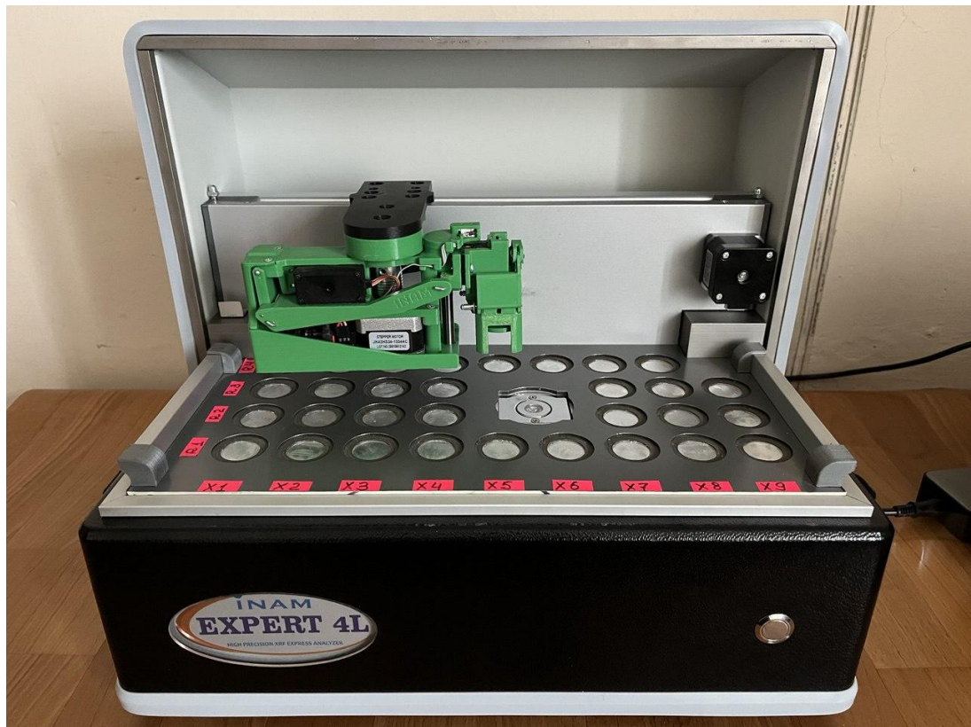
Рисунок 3.1 – Загальний вигляд аналізатора EXPERT 4L, за допомогою якого досліджувався хімічний склад шихти
