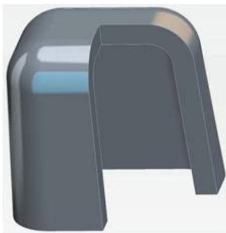
Рисунок 1.19 – 3D-модель екзотермічної оболонки № 2
