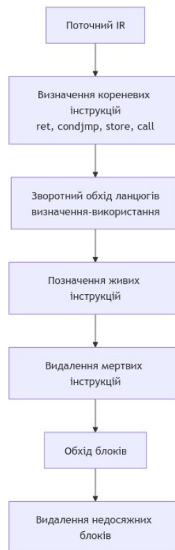
Рисунок 2.8 – Схема оптимізації DCE
