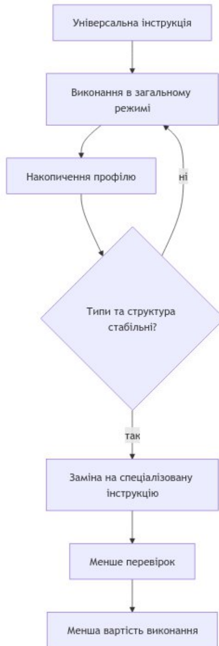
Рисунок 2.12 – Схема спеціалізації байт-коду
