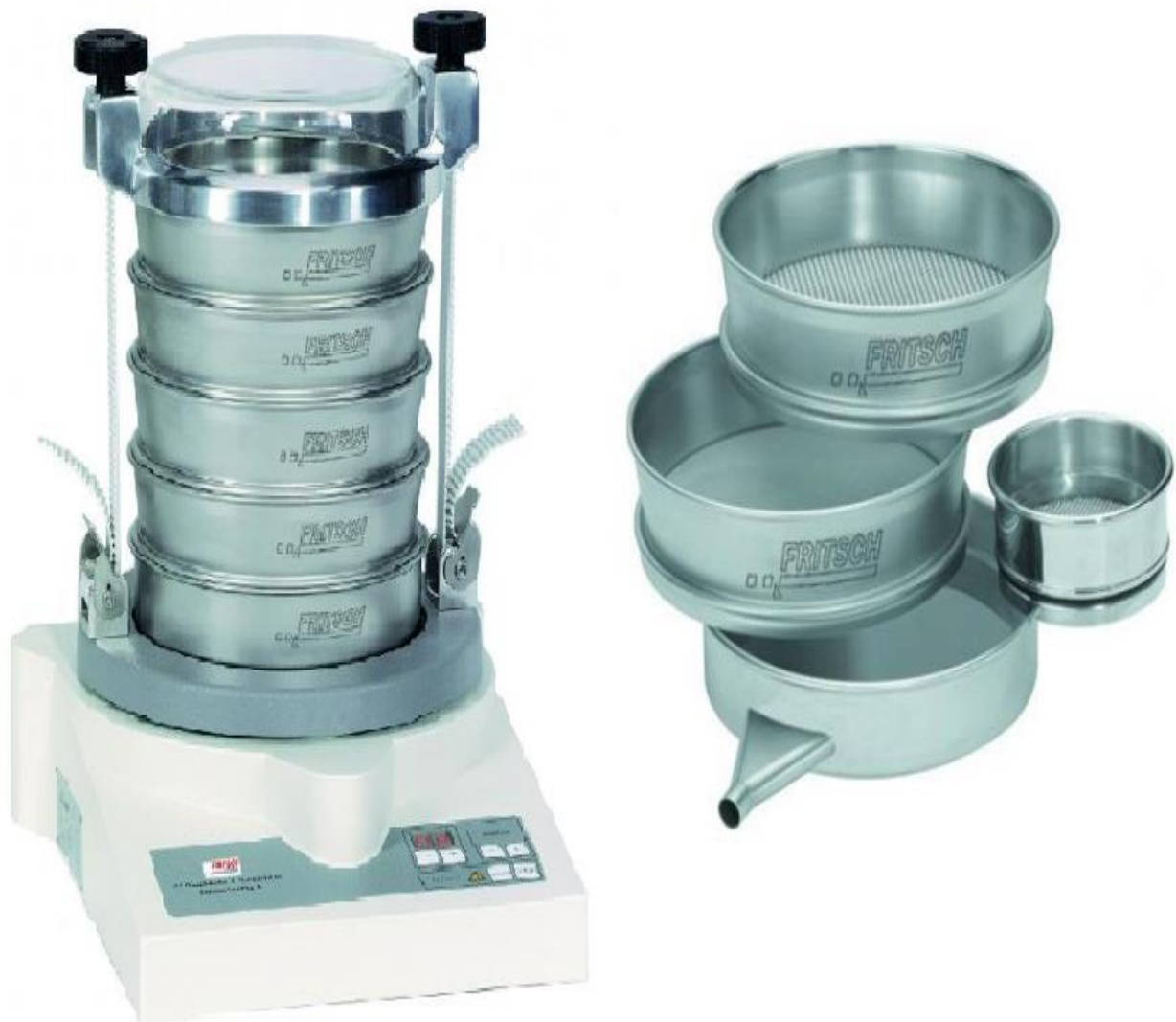
Рисунок 2.2 - Вібраційний грохот із ситовою колоною (ліворуч) та набір сит (праворуч) (Fritsch, Німеччина)
