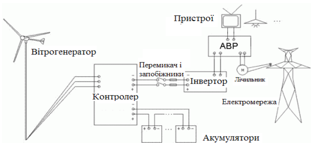
Рисунок 5. 2 - Вітрогенератор (з акумуляторами) и комутація з мережею
