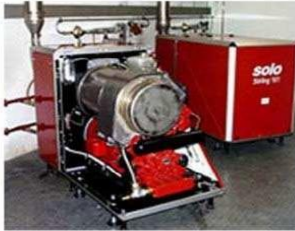
Рисунок 7.2 – Когенераційна установка на базі поршневого двигуна
