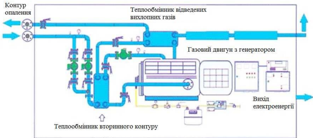
Рисунок 7.4 – Принципова схема газопоршневої когенераційної установки
