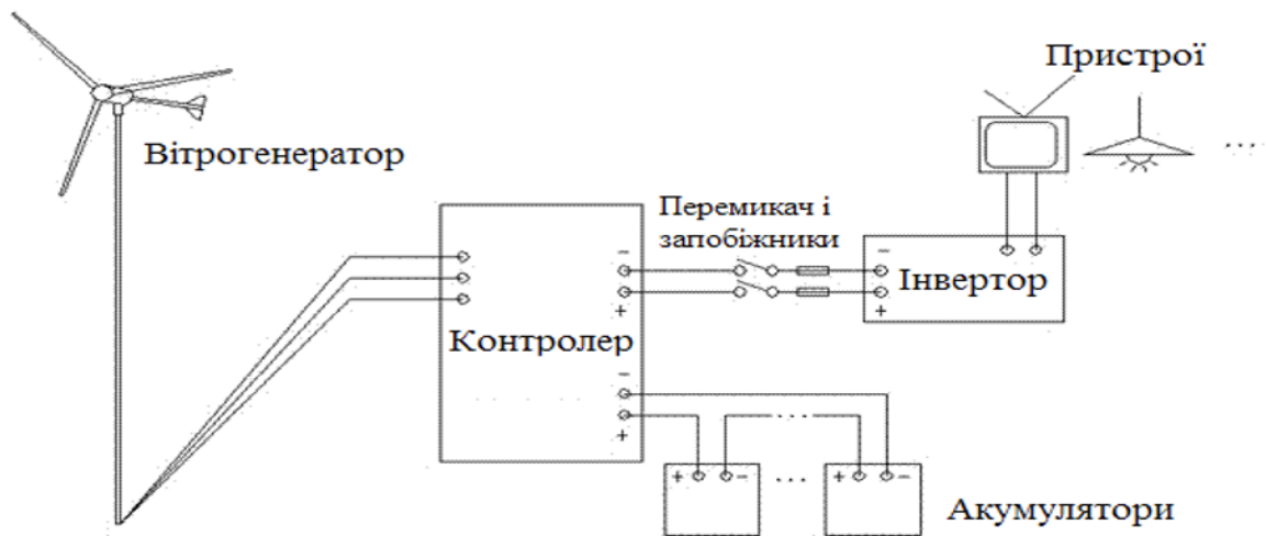
Рисунок 5. 1 - Автономне забезпечення об'єкта (з акумуляторними батареями)
