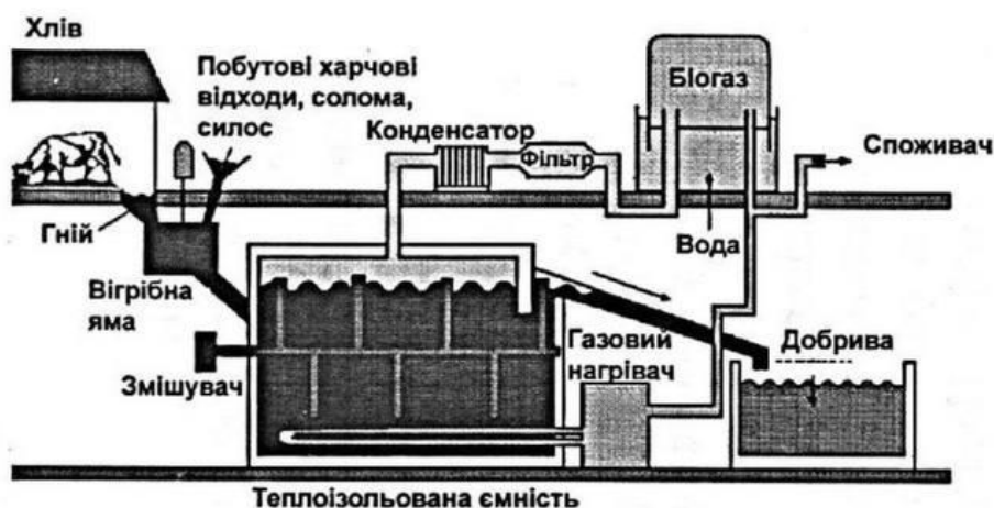
Рис. 6.2 – Схема біогазової установки [2]
