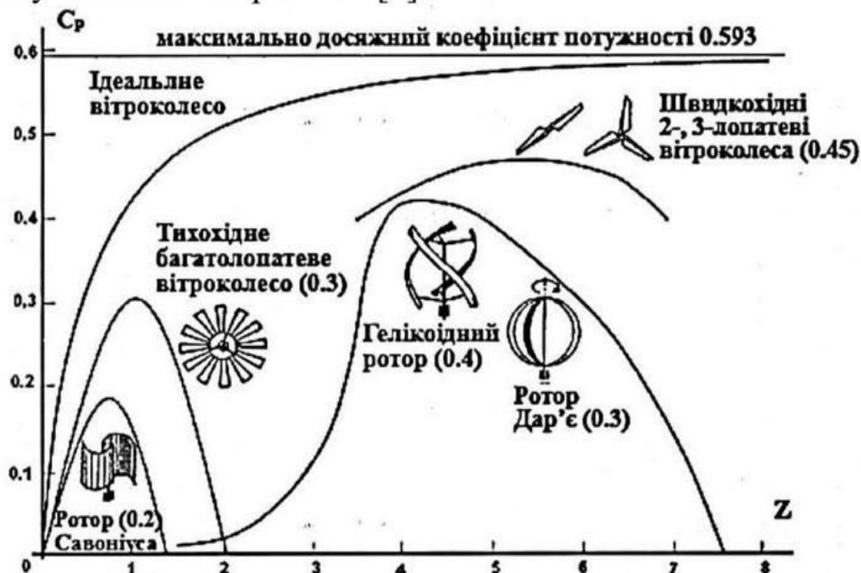
Рис. 4.4 – Значення коефіцієнту потужності різних типів вітроколес [2]
