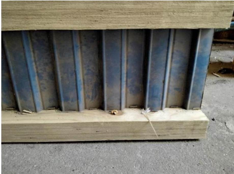
Рисунок 7 – Балка двотаврова дерев'яно-металева з поясами з LVL
