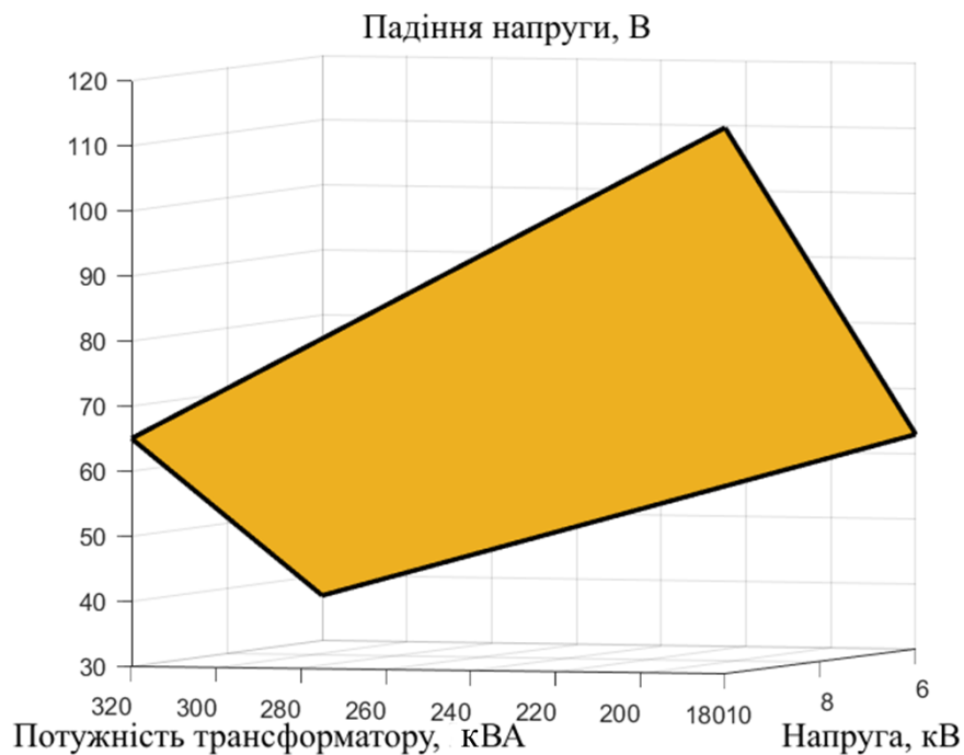
Рисунок 2.20 – Тривимірний розподіл падінь напруги в функції номінальної потужності трансформатора та рівнів його первинної напруги
