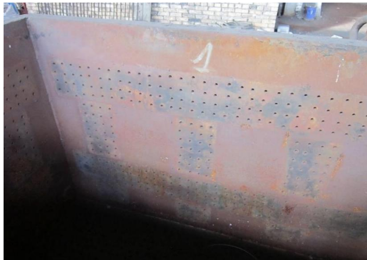
Рисунок 3.12 - Вакуумована опока з бічним і нижнім забором повітря
