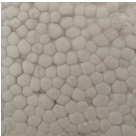
Рисунок 3.1 - Структура моделі комплексного складу: 40% будівельного полістиролу марки ППС-20; 60% ливарного полістиролу марки ПСВ-1Л
