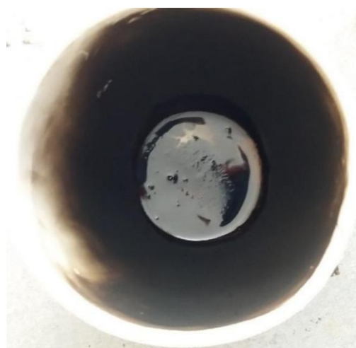
Рисунок 3.4- Зразок №4 (вміст ливарного полістиролу 100%)
