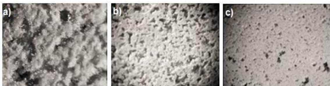
Рисунок 3.6 – Мікроструктура поверхні оболонкових форм (x60): а) Армосила, б) Людекса с) Етилсилікату
