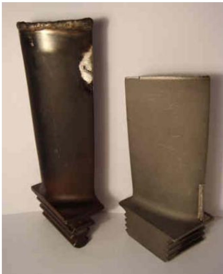
Рисунок 6.1 - Методи відновлення лопаток наплавлення електродуги і імпульсного лазерного наплавлення.
