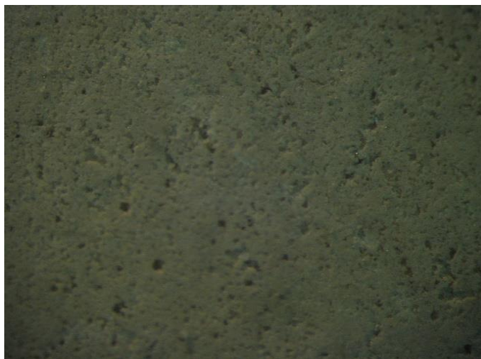
Рисунок 3.7 – Контактна поверхня керамічної форми (фрагмент) на основі китайського сполучного GN-25 (вміст \text{SiO}_2 25 %)+ 10 % латексу і кварцового піску ( \times 56 )
