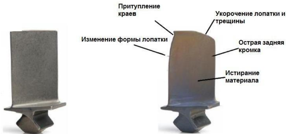
Рисунок 1.2 – Вилив турбінної лопатки до і після експлуатації
