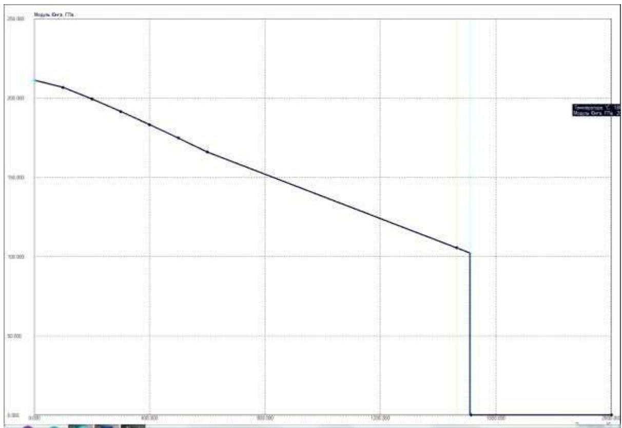
Рис. 3.14. Залежність модуля Юнга для сплаву SS1505 від температури
