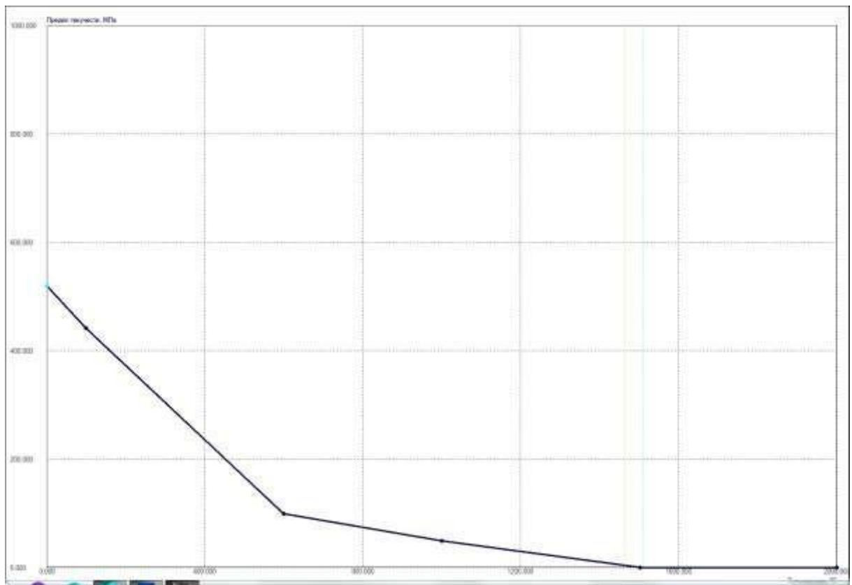
Рис. 3.16. Залежність межі плинності для сплаву SS1505 від температури
