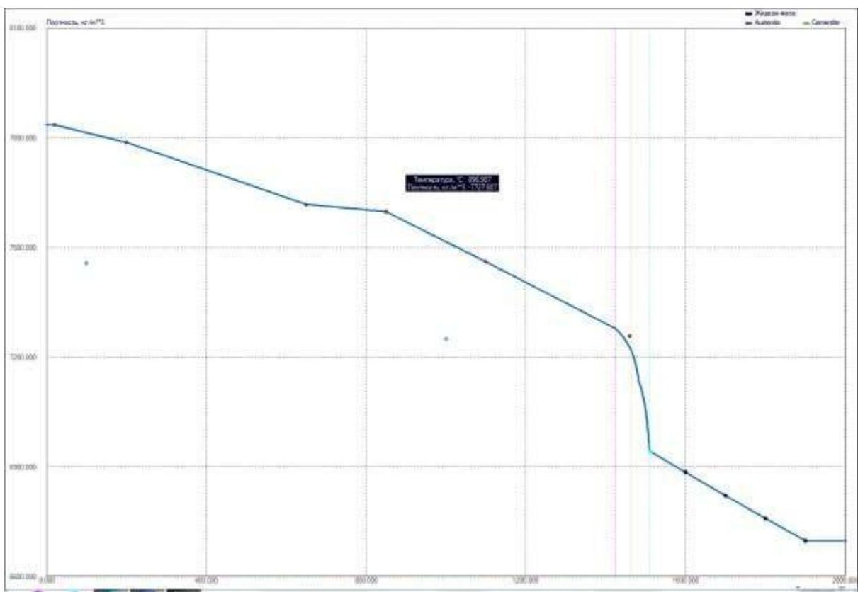
Рис. 3.12. Залежність питомої теплоємності для сплаву SS1505 від температури
