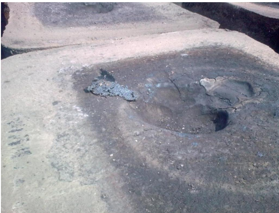
Рис. 2.21 Розмивання робочої частини піддону струменем рідкого металу при заливці зверху
