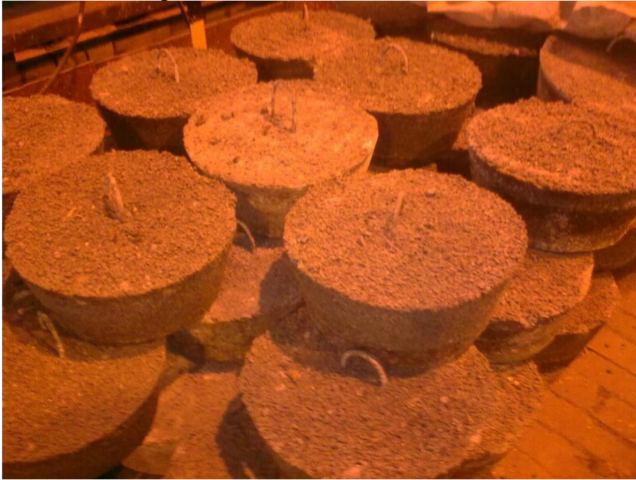
Рис. 2.20 Металокерамічні пробки для встановлення у піддон
