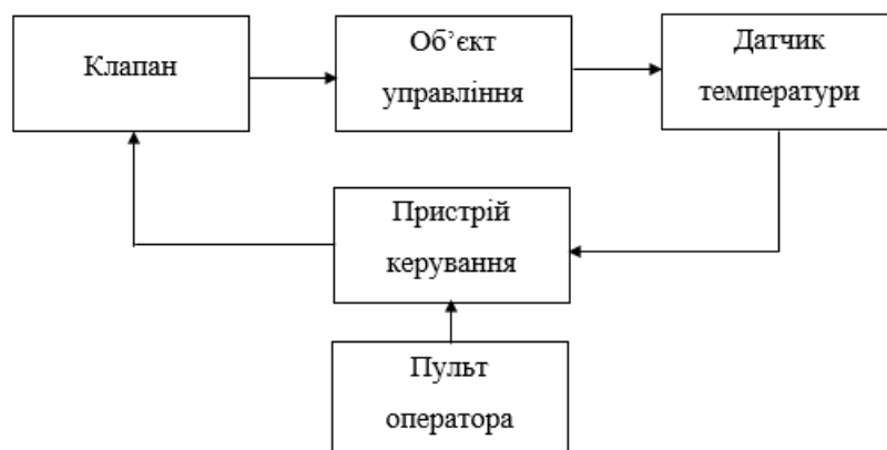
Рисунок 1.8 – Структурна схема системи автоматичного керування
