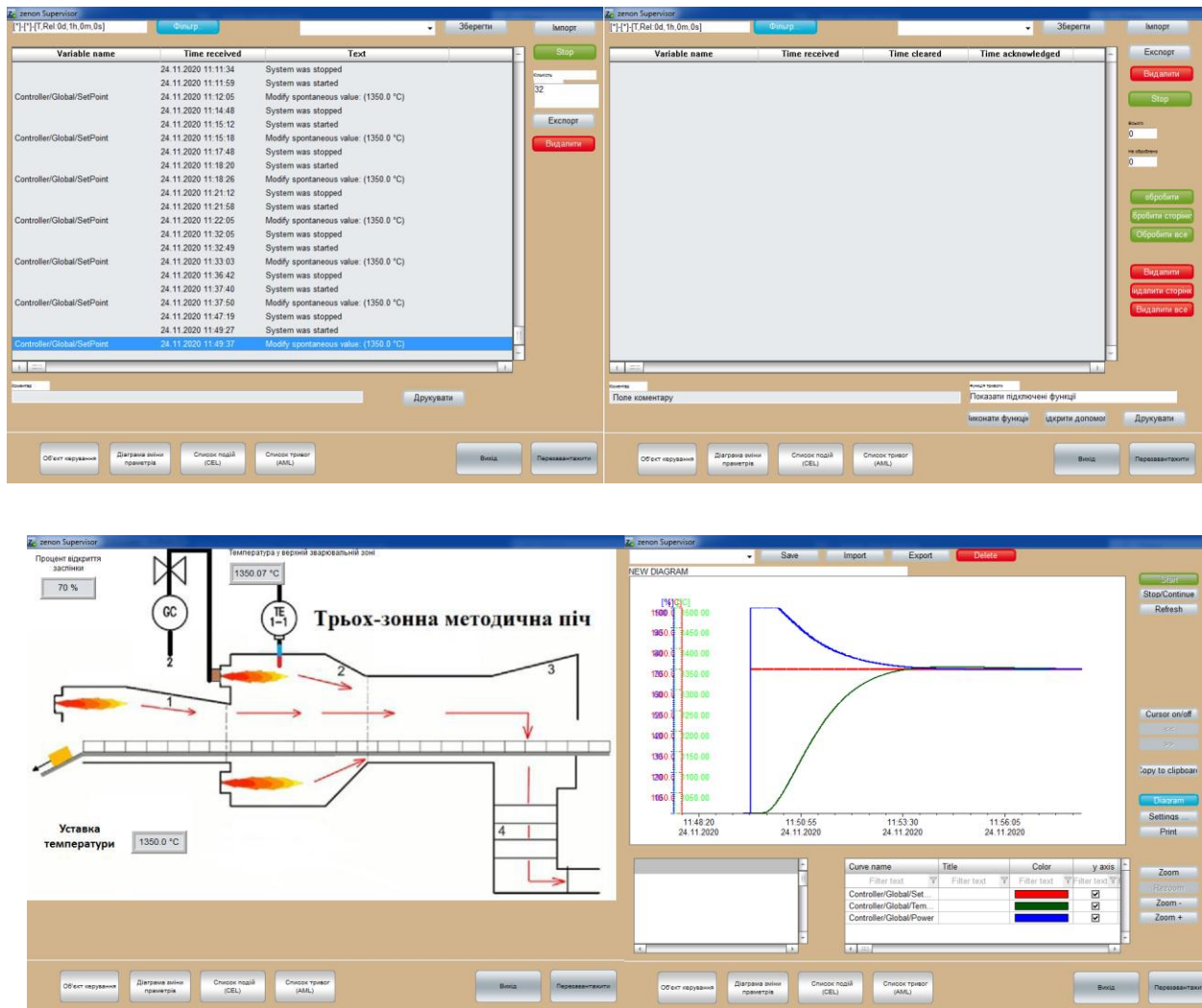
Рисунок 3.24 – Перевірка функціонування програмного забезпечення системи автоматичного керування
