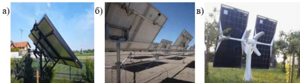
а) слідкуючі системи регулювання; б) програмне регулювання; в) екстремальні системи регулювання
