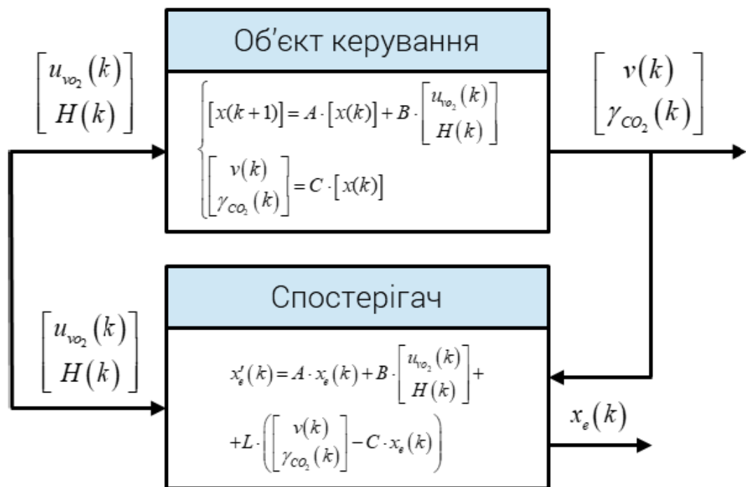
Рисунок 2.9 - Структурна схема спостерігача стану системи
