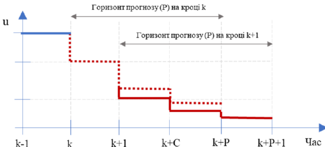
Рисунок 2.7 - Загальна схема управління динамічними системами із застосуванням модельно-прогнозуючого методу
