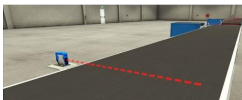
Рисунок 2.3 – Виставлені кінцеві датчики
