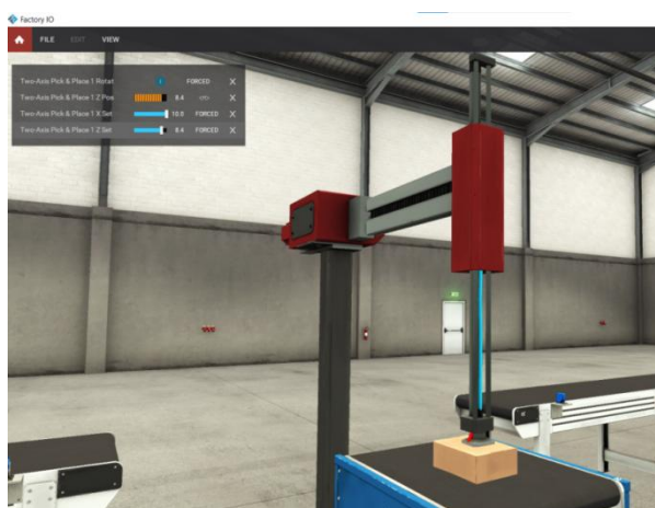
Рисунок 2.10 – Визначення висоти опускання руки
