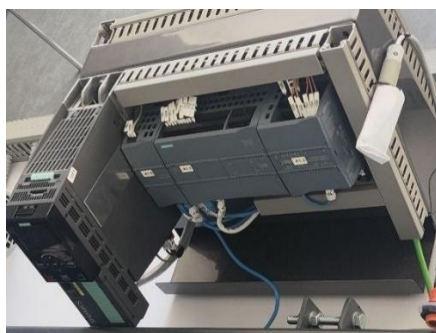
Рисунок 1.4 – Вид Комунаційного модуля, ПЛК, вагового модуля SIWAREX WP231 ETHERNET
