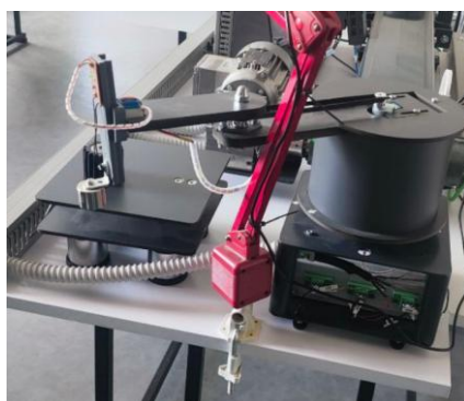
Рисунок 1.3 – SCARA-robot в зоні зважування з інтегрованим датчиком SIWAREX
