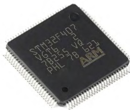
Рисунок 3.4 – Мікропроцесор ARM Cortex-M4 Мікропроцесор ARM (Advance RISC Machine) це один з ліцензованих процесорних ядер.
