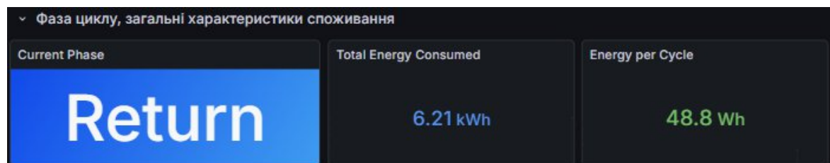
Рисунок 3.26 - Панель з виведенням фази циклу pick-and-place, споживаної енергії за весь час та споживаної енергії за один цикл
