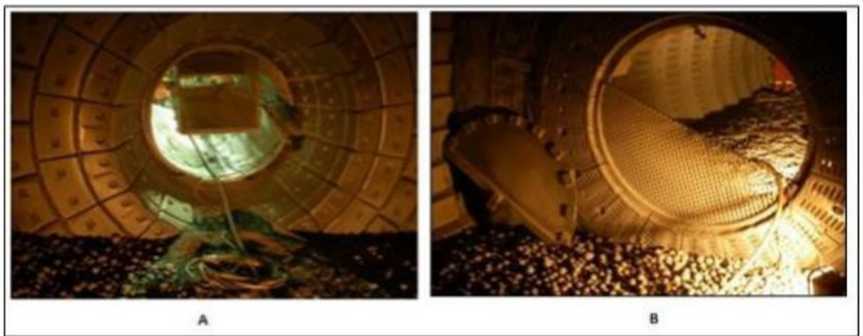
Рисунок 1.5 – Т-ребристий кульовий млин з двома відділеннями. А-відсік 01, В-відсік 01/02 і мембранний сепаратор [4].
