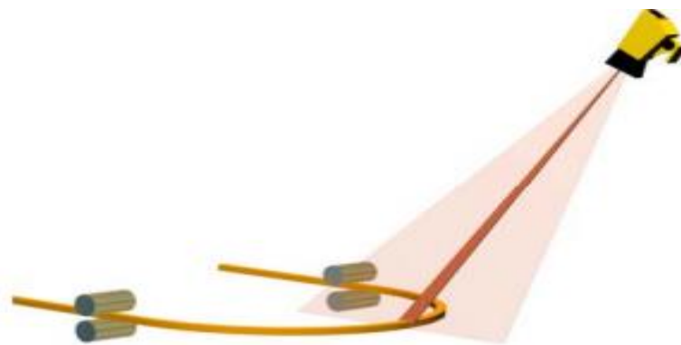
Рисунок 1.3 – Керування горизонтальним контуром петлі дроту
