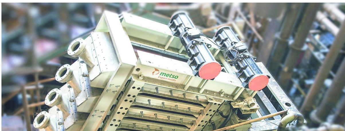
Рисунок 1.9 – Компактний грохот тонкого грохочення компанії Metso
