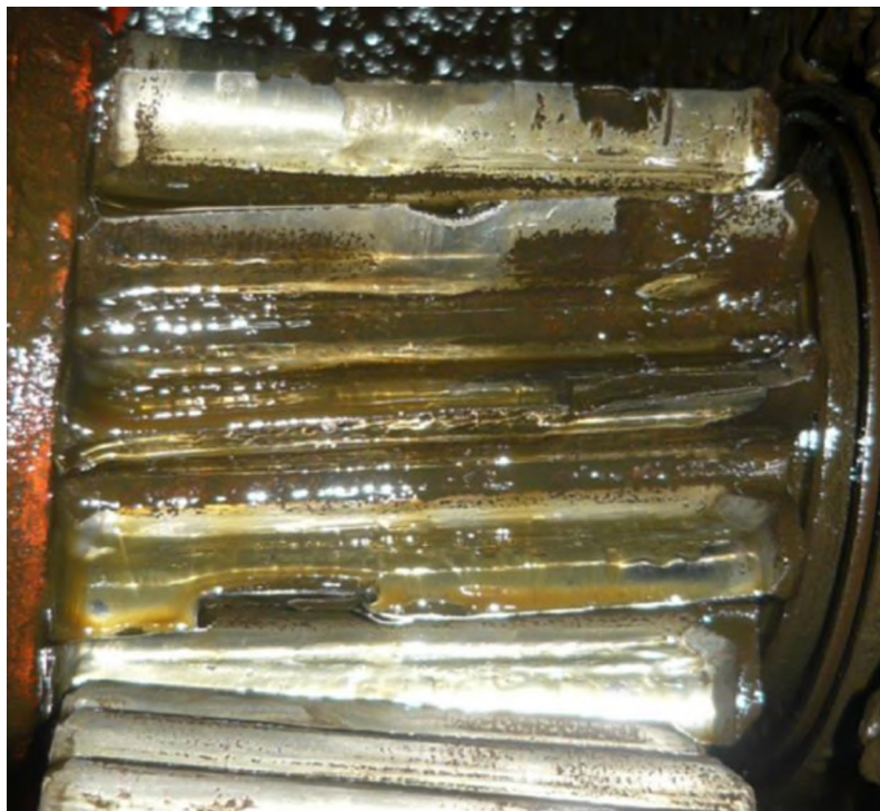
Рисунок 7.11 – Часткове вигинне руйнування та викришування зубів «бетової» шестерні портального крана КПП 5/30
