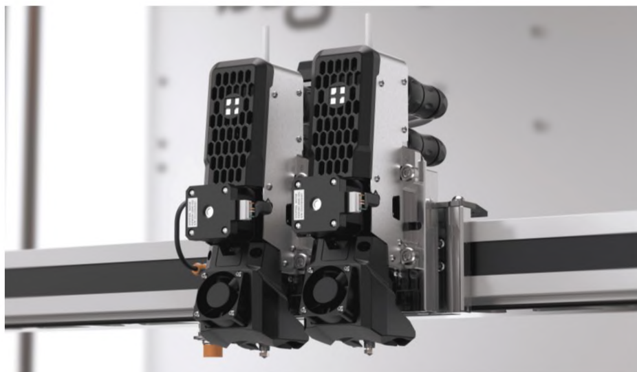
Рисунок 6.4 – Друкуючі голівки принтера на напрямних
