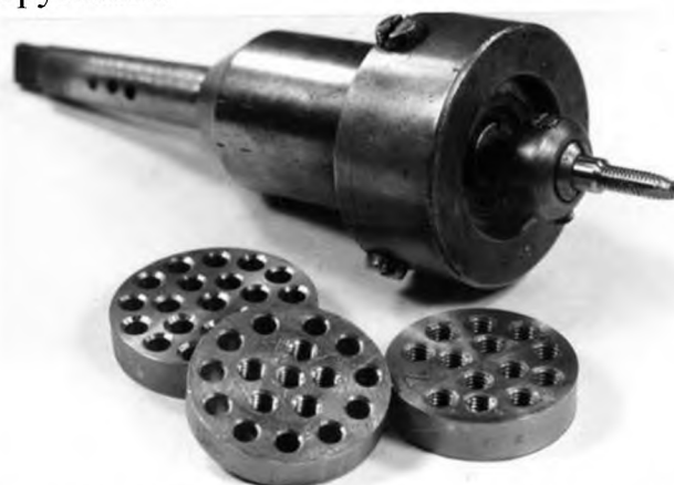
Рисунок 7.6 – Плаваючий самоцентруючий патрон для різьборізних мітчиків та приклади деталей
