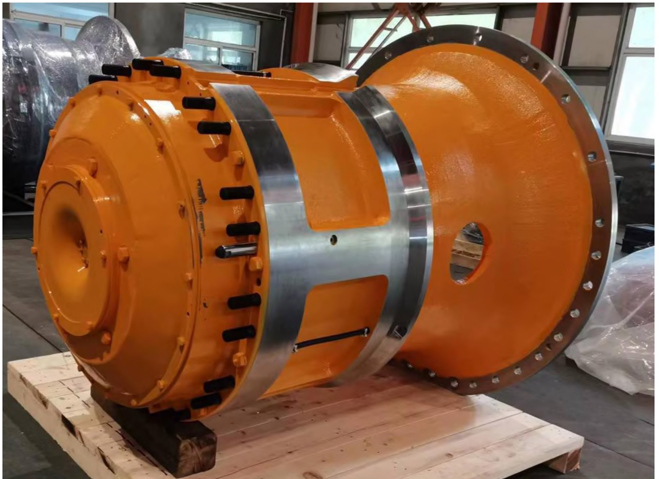
Рисунок 1.5 – Мотор-редуктор самоскида БелАЗ-7514
