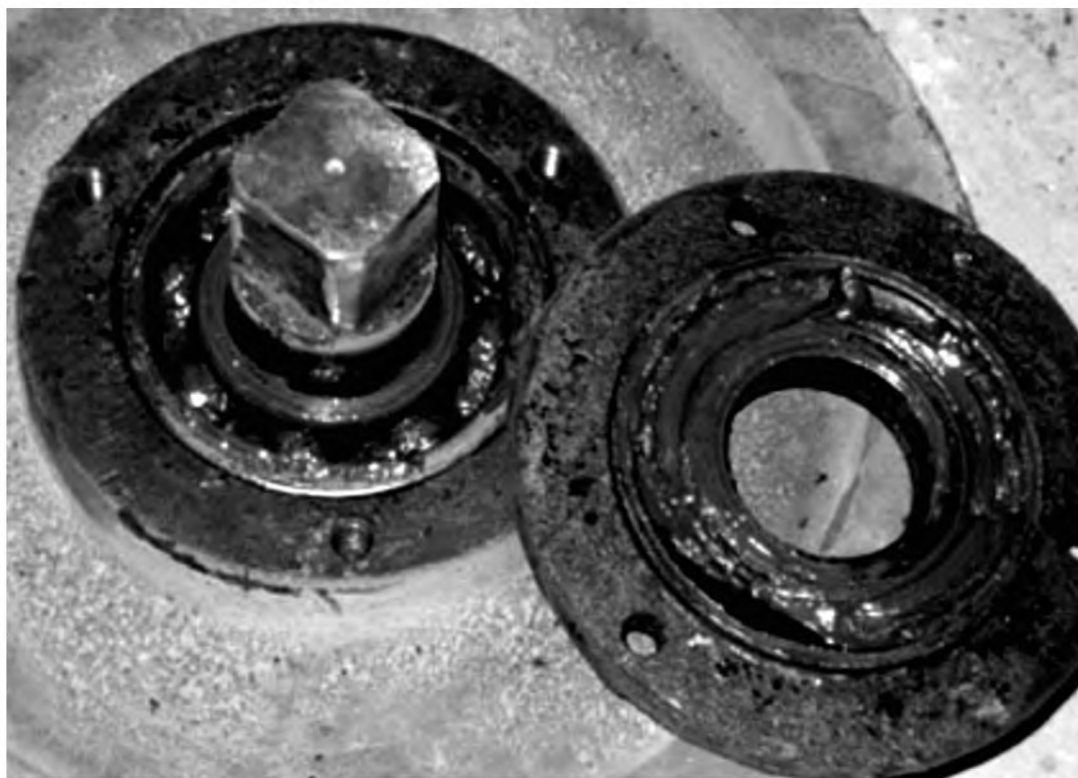
Рисунок 7.2 – Стандартна мастило після тривалої експлуатації практично висохла і відшаровується
