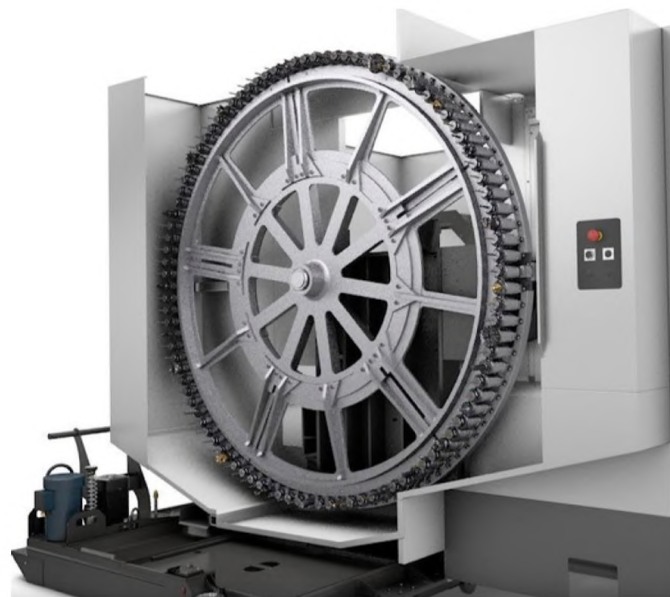
Рисунок 4.2 – Робочі органи верстата Haas EC-400
