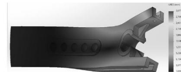
Епюра переміщення матеріалу під дією навантажень
