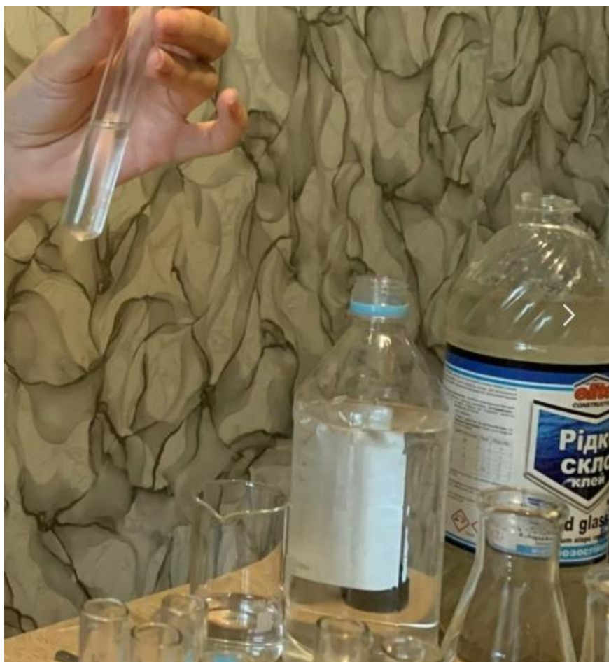
Рис.2.2 Процес створення розчину силікату натрію
