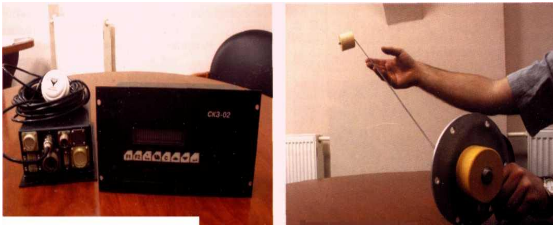
Рис.1.2. Контроллер СК3-02 та датчик рівня палива в баку
