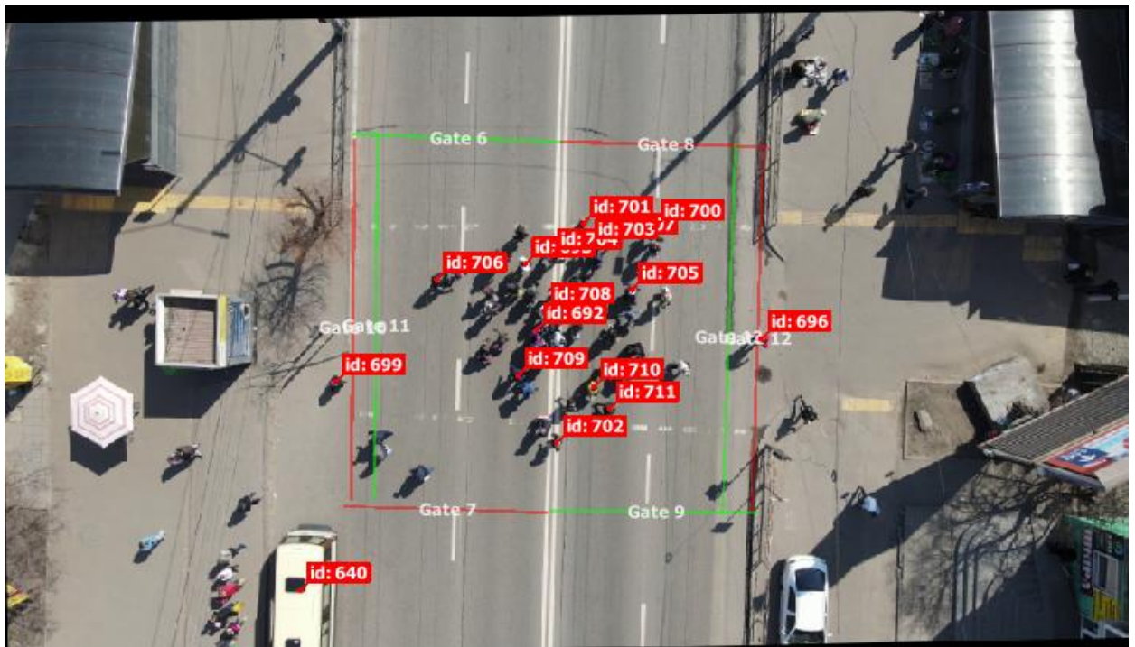
Рис.3.3. Позначення робочого простору у DataFromSky Viewer
