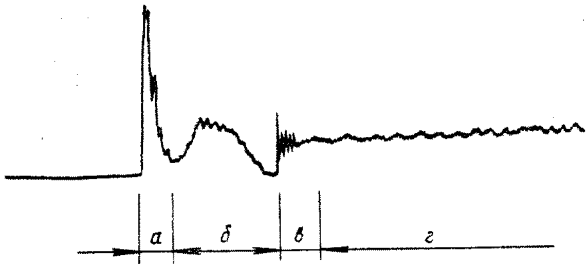
Рисунок 3.4 – Осцилограма коливань крутного моменту під час запуску дробарки під завалом:
