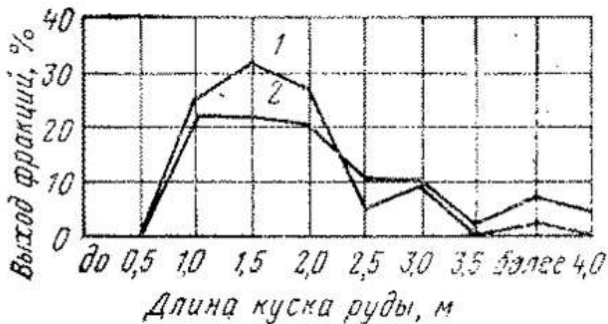
Рис 1.4 – Гранулометричний склад руди у дучках: 1 – ділянка 1; 2 - ділянка 2 [14]
