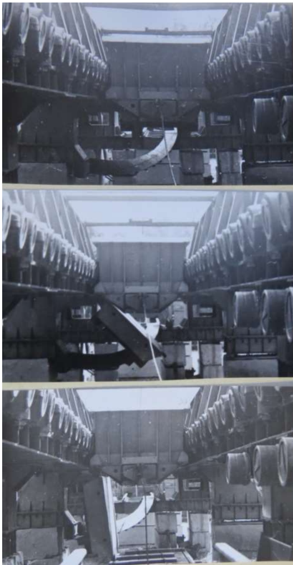
Рисунок 4.4 – Стадії руху вагонетки через розвантажувальний пристрій
