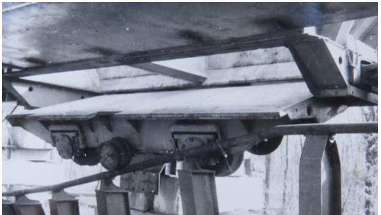
Рисунок 4.5 – Варіанти виконання розвантажувального пристрою: а – взаємодія напрямного елемента з ходовим колесом вагонетки; б - взаємодія напрямного елемента з додатковим котком, закріпленим на днищі вагонетки
